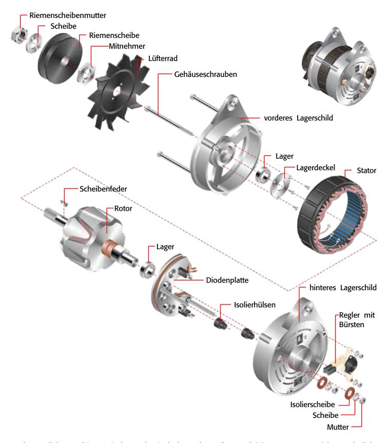
Drehstromlichtmaschinen sind, mechanisch betrachtet, ihren Gleichstromvettern nicht unähnlich. In beiden Stromerzeugern läuft ein Rotor (auch Läufer oder Anker genannt) in einem Gehäuse, in dem eine oder, bei der Drehstrommaschine, mehrere Wicklungen fest angebracht sind. Das Gehäuse ist an beiden Enden mit Deckeln, auch Lagerschilde genannt, versehen, in denen sich die Lagersitze des Rotors befinden. Obwohl Drehstromlichtmaschinen mechanisch wesentlich
